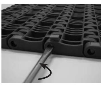
③チェーンを連結する際は、チェーンの両端を引き寄せて組合わせ、一端よりピンを挿入します。チェーンの裏側よりスナップアタッチメントを挿入します。このとき、リンク下面よりスナップアタッチメントが飛出していないことを確認ください。
