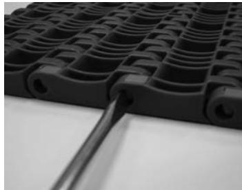
②ネジ付ドライバを回転させて、ピンのセンタ穴(Φ1.0)に食込まれ、ピンを引抜きチェーンを分解します。
