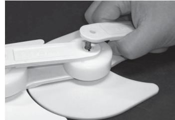
1. 継手ピンからスナップピンを抜き、オフセットリンクを外してください。
