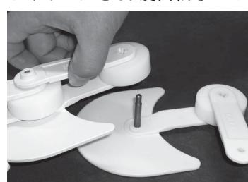
3. 継手ピンを本体リンクごと前のリンクから抜き取ってください。
