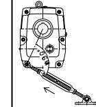
左図の様に、出力軸芯とタイロッドボルトを結ぶ線に対して概ね90° 垂直方向にタイロッドが引張り力を受けるように取付けることが理想的です。矢印は出力軸回転方向とタイロッドを受ける力の方向を示します。
