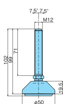
材質：ボルト = ステンレス鋼 (SUS304)
