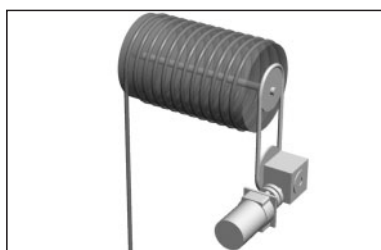
ブレーキ付モータ+カップリング+ウォーム減速機 +チェーン+スプロケット
