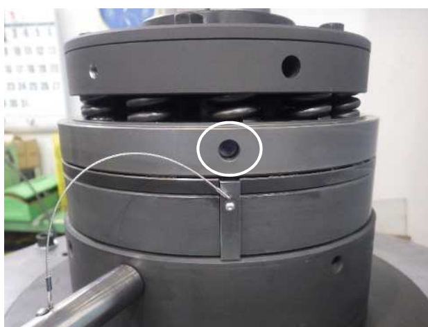
復帰操作が完了した状態 写 6
