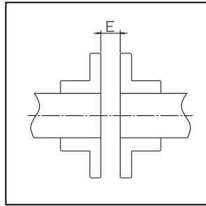
E寸法を90度毎に4箇所測定し、その平均値が $E \pm 0.25$  mm以内となるようハブの位置を調整してください。駆動軸、被動軸が段付きシャフトの場合は、調整代が制限される場合がありますのであらかじめE寸法が調整可能なように配慮ください。
