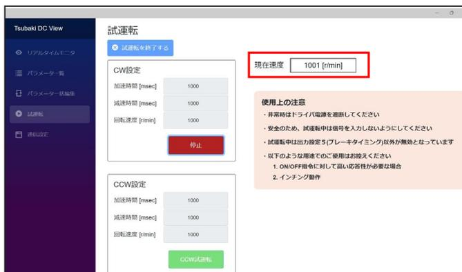
2 モータが回転し、「現在速度」欄に現在の回転数が表示されます。
