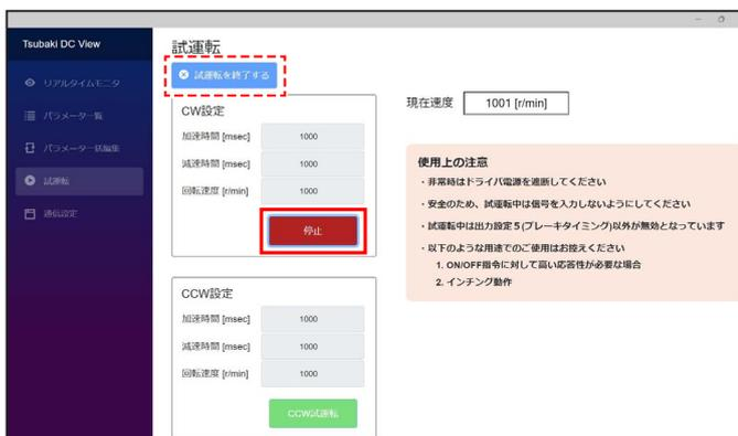
3 「停止」ボタンをクリックすると、モータが停止します。「試運転を終了する」ボタンをクリックすると、他のメニューへの移動が可能になります。
