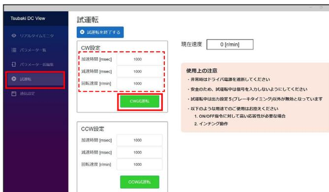
1 「試運転」メニューでCW設定のパラメータを任意の値に設定し、「CW試運転」ボタンをクリックします。
