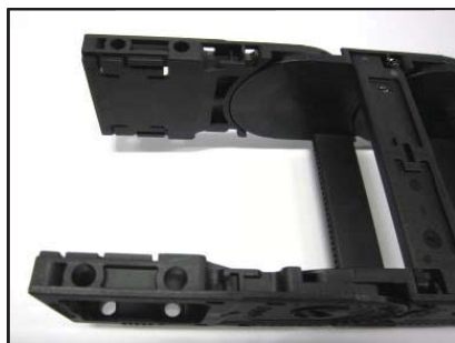
②本体リンクにブラケットのリンク 部分を取付けます。
