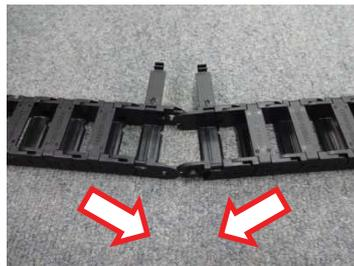
②リンク部を重ね、次に一方のピンを孔に挿入します。
