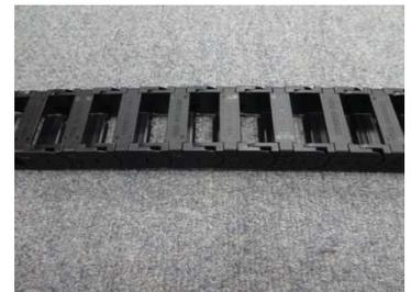
③他方も押し込み、ピンを孔に挿入連結し、アームを組込みます。
