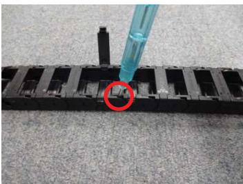
①分割位置の凹部（○印内）にマイナスドライバー（先端幅2～3mm）を差込みます。
