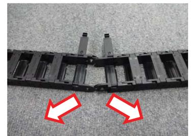
③他方のピンを支点にしてケーブルベヤ本体を「く」の字に曲げると外れ、分割されます。
