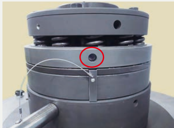
復帰操作が完了した状態
