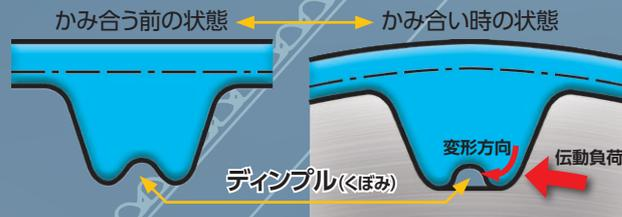
かみ合い時に上図のようにベルトの歯先部分が変形し、衝突エネルギーを吸収するため、騒音が大幅に低下します。
