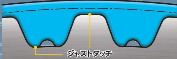
つばきタイミングベルト使用時、歯先と歯底が隙間なく接触する(ジャストタッチ方式)ので、多角形運動がなく、回転ムラを抑えた高精度な伝動が可能です。またバックラッシュも小さく、高い位置決め精度を保ちます。
