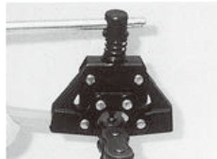
図 9. ローラチェーンの支持 (RS-CS-B 形チェーンスクリュ)
