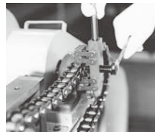
図5. チェーンスクリュによる切り方
