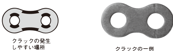
図40. プレートのクラック
