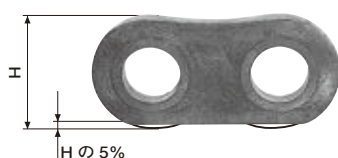
図41. プレート端面の摩耗
