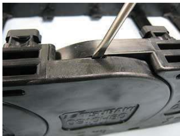
溝にドライバーを差し込む。
