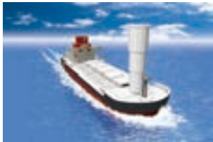
硬翼帆式風力推進装置(昇降)
