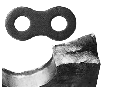
② Fatigue fracture
